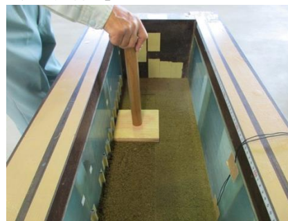
③【締固め状況】
