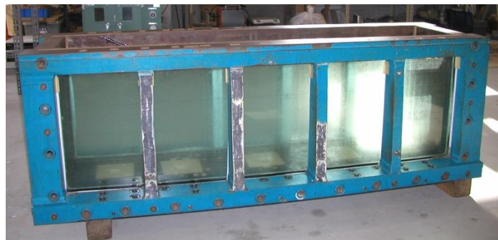
【動的大型土槽（土木研究所資料）】
