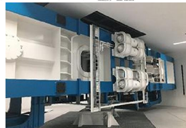
【大型動的遠心力载荷試験装置の概要（土木研究所資料）】
