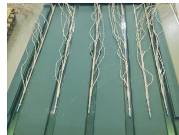
補強材完成(ひずみゲージ付)
