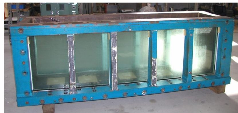
【動的大型土槽（土木研究所資料）】
